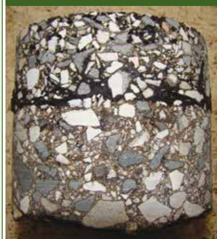
Risultati sperimentali - Valori medi (in foto un provino con strato inferiore stabilizzato)
