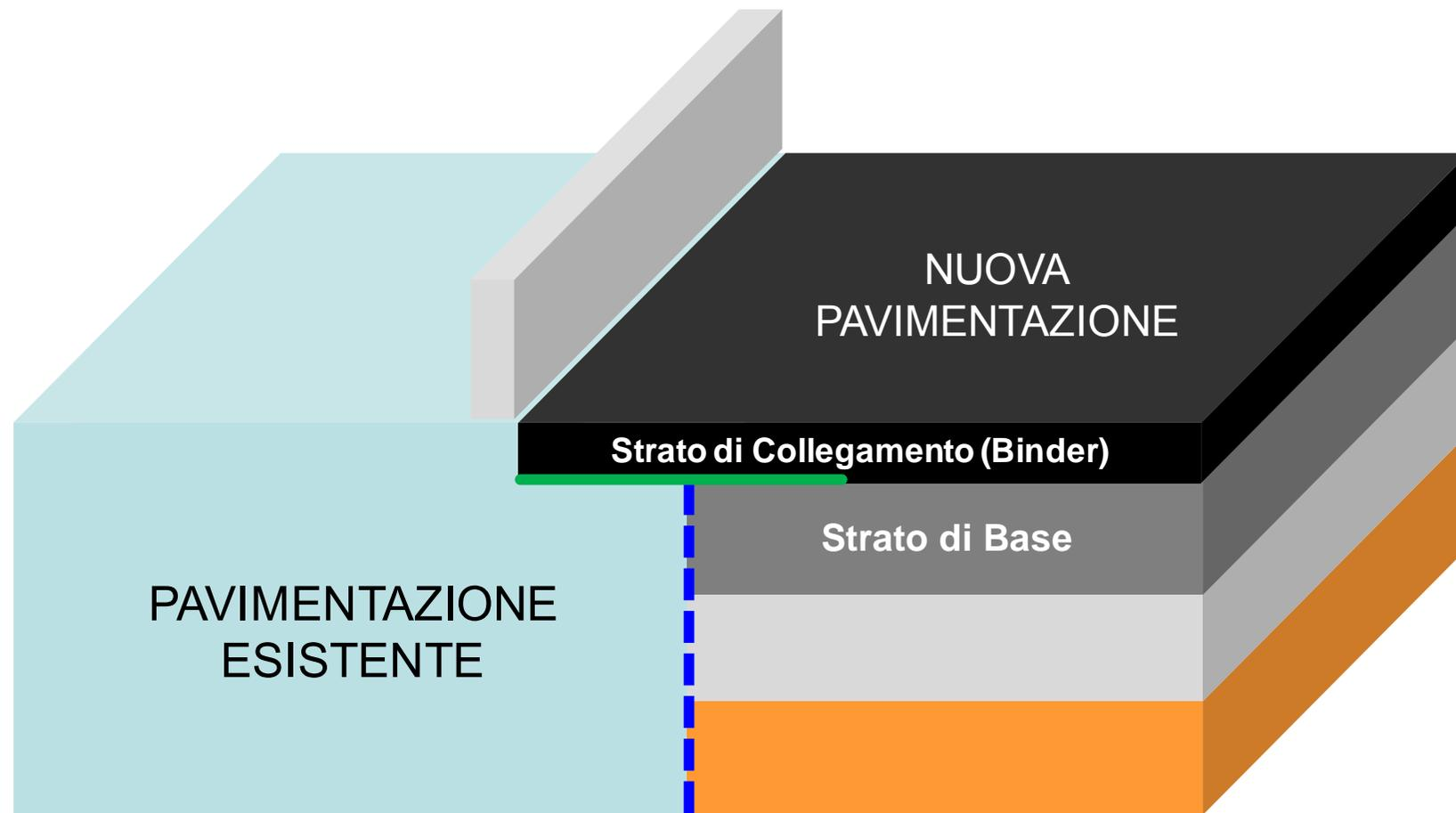
**Giunto Longitudinale di Costruzione**
